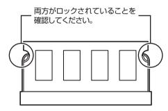
正しくロックされている場合は、メモリが水平で、端子の金色の部分が少し(1mm程度)見える状態です。
