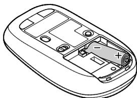
単3形アルカリ乾電池またはニッケル水素電池をマウス内部に向けて押し込み、後方を端子に合わせて入れてください。乾電池の+と-の向きを、電池ボックス内の表示どおりに入れてください。
