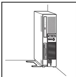
1つのスタビライザのみをセットする場合は、転倒防止のため、必ず反対側の側面を壁などに付けて使用してください。
