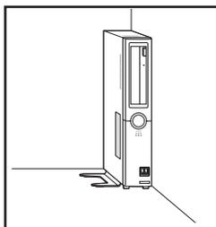
1つのスタビライザのみをセットする場合は、転倒防止のため、必ず反対側の側面を壁などに付けて使用してください。
