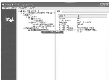
「RAID以外のハードドライブ」配下に表示されているハードドライブを右クリックし、「このハードドライブに再構築」、または「スペアとしてマーク」を選択します。画面の指示にしたがってRAIDの再構築をおこなってください。それでも、再構築できない場合は、次の「再セットアップしてRAIDを再構築する」(67ページ)をご覧ください。
