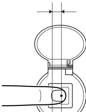
爪の付け根の位置とセンサの中心が重なり、正しい位置に置いているように見えますが、この状態を真上や横から見ると、右の図のように爪の付け根がセンサの中心から手前にずれていて、正しい位置にないことがわかります。
