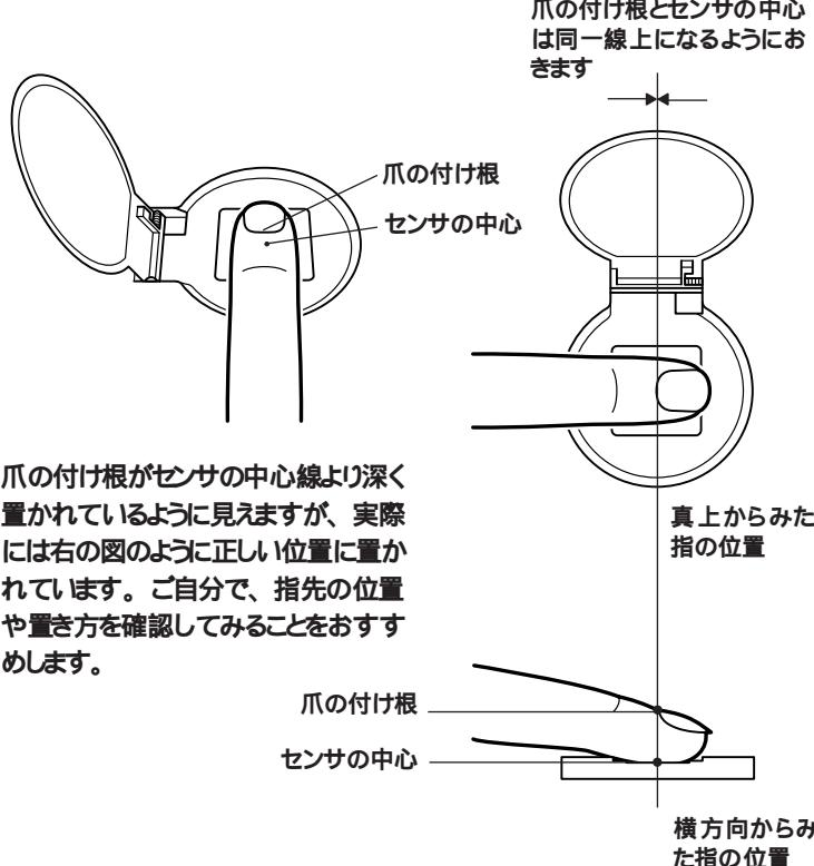
爪の付け根がセンサの中心線より深く置かれているように見えますが、実際には右の図のように正しい位置に置かれています。ご自分で、指先の位置や置き方を確認してみることをおすすめします。
