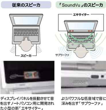
ディスプレイパネルを振動させて音を出すノートパソコン用に開発された小型の新「エキサイター」
