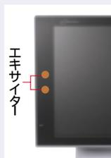
ディスプレイパネルを振動させて音を出す「エキサイター」
