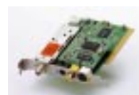
3次元Y/C分離回路とデジタルノイズリダクション機能を搭載したTVチューナボードを装備。
